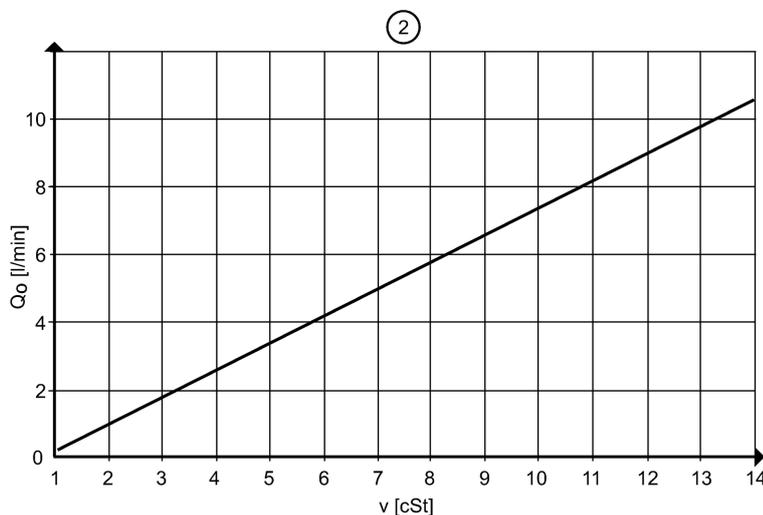
Ansprechschwelle  $Q_{\min}$  in Abhängigkeit von der kinematischen Viskosität
